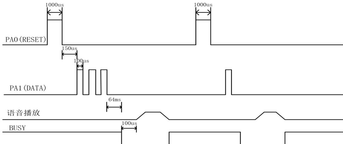
数脉冲控制时序中，先拉高 RESET 信号 1000us，然后发送 DATA，DATA 中的脉冲高电平需要保持 100us 的高电平，且两个脉冲之间的间隔时间需要 100us。脉冲数据发送完后 64ms，BUSY 信号输出。BUSY 输出 100us 后开始播放地址语音，语音播放结束 BUSY 也发生变化。
