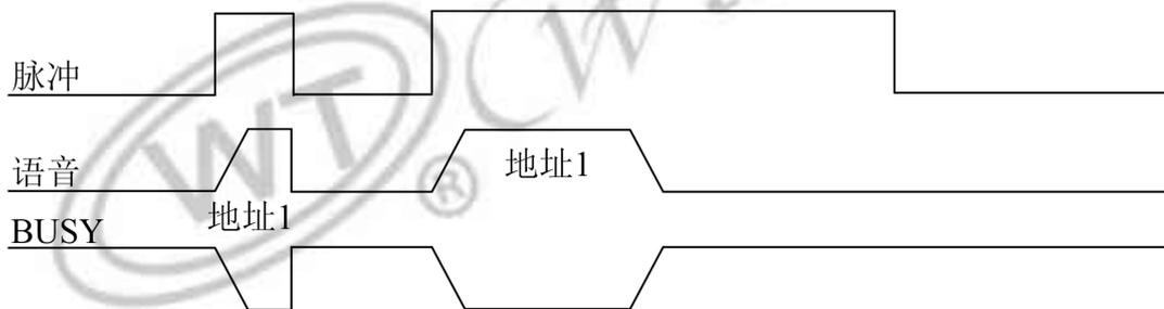
备注：高电平触发。当 I/O 口为高电平时，保持播放，低电平则停止。当第一遍播放结束后，还保持高电平，也不会继续播放，触发后只播放一次就结束。如果需要重新播放，则需要让 I/O 口处于低电平，再拉为高电平，而后保持高电平即可。
