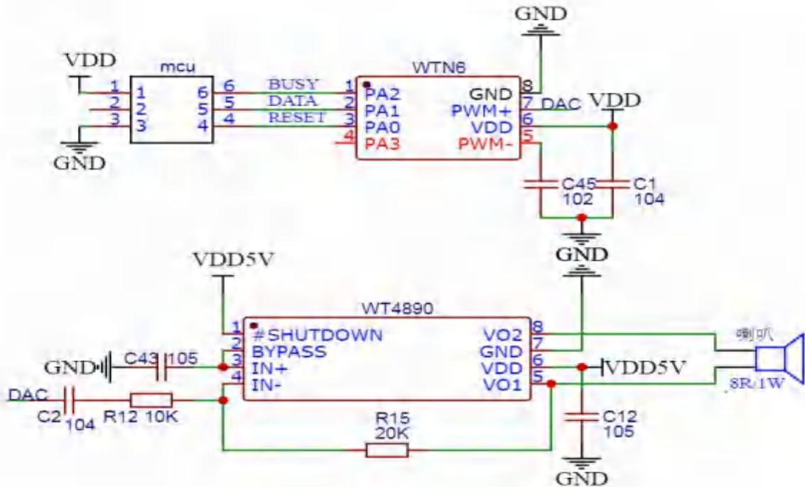
注意：布线时电容 C1 尽量靠近 WTN6 芯片 VDD 脚，以增强 WTN6 系列语音芯片的抗干扰能力。在 DAC 输出模式下，PWM-脚必须接 1nf 电容到地，DAC 输出可根据需求外接功放，以驱动更大功率的喇叭。
