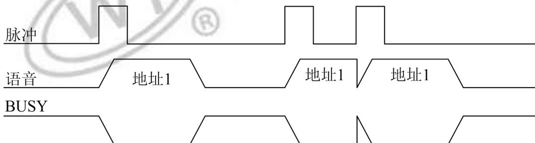
备注：正脉冲触发。当 I/O 口检测到有上升沿时，触发播放语音。在语音播放期间，再检测到上升沿，芯片会打断正在播放的语音，重新播放。只要有上升沿信号，就重新播放。
