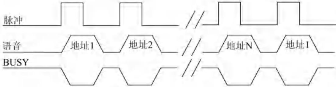
备注：正脉冲触发。用一个按键触发播放语音。一个正脉冲触发播放一段语音，下一个脉冲触发播放下一段语音，重复操作，播放完最后一段语音，则会点播到第一段语音，如此循环触发播放语音。
