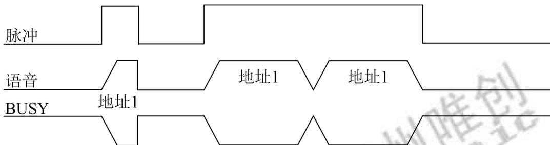
备注：当 I/O 口为高电平时，保持播放，低电平则停止。当第一遍结束后，还保持高电平，则继续重新播放，直到转变为低电平才停止。只要是高电平，则有声音；低电平，则没声音。
