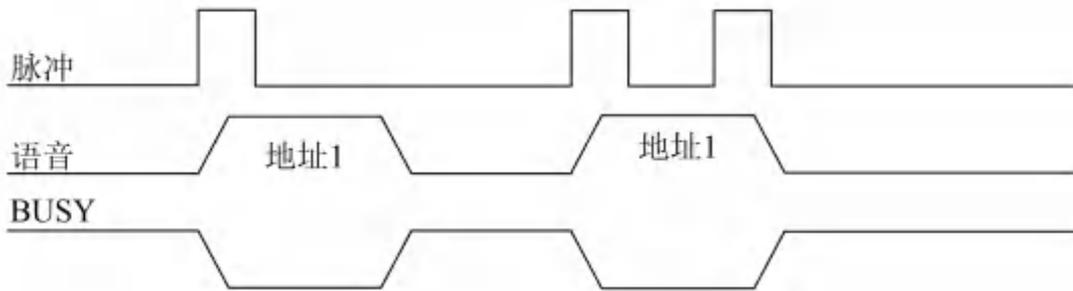
备注：正脉冲触发。当 I/O 口检测到有上升沿时，触发播放语音。在语音播放期间，再检测到上升沿时，芯片不动作。直到语音结束后，检测到的上升沿才有效。
