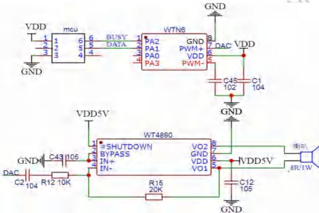
注意：布线时电容 C1 尽量靠近 WTN6 芯片 VDD 脚，以增强 WTN6 系列语音芯片的抗干扰能力。在 DAC 输出模式下，PWM-脚必须接 1nf 电容到地，DAC 输出可根据需求外接功放，以驱动更大功率的喇叭。
