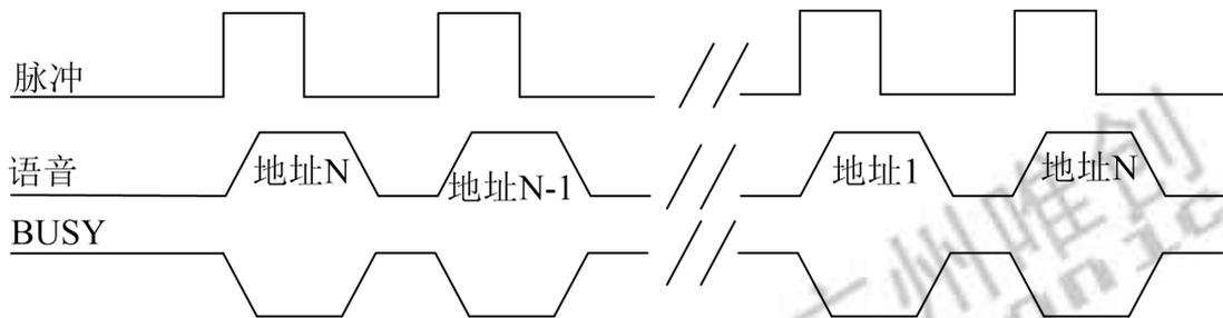
备注：正脉冲触发。用一个按键触发播放语音。一个正脉冲触发播放一段语音，下一个脉冲触发播放上一段语音，重复操作，播放完最前一段语音，则会点播到最后一段语音，如此循环触发播放语音。
