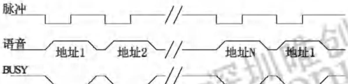
备注：负脉冲触发。用一个按键触发播放语音。一个负脉冲触发播放一段语音，下一个脉冲触发播放下一段语音，重复操作，播放完最后一段语音，则会点播到第一段语音，如此循环触发播放语音。
