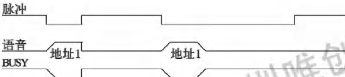
备注：低电平触发。当 I/O 口为低电平时，保持播放，高电平则停止。当第一遍播放结束后，还保持低电平，也不会继续播放，触发后只播放一次就结束。如果需要重新播放，则需要让 I/O 口处于高电平，再拉为低电平，而后保持低电平即可。
