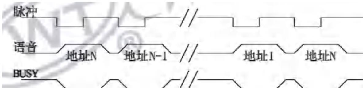
备注：负脉冲触发。用一个按键触发播放语音。一个负脉冲触发播放一段语音，下一个脉冲触发播放上一段语音，重复操作，播放完最前一段语音，则会点播到最后一段语音，如此循环触发播放语音。
