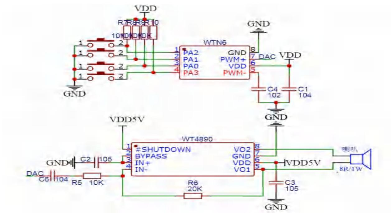
注意：布线时电容 C1 尽量靠近 WTN6 芯片 VDD 脚，以增强 WTN6 系列语音芯片的抗干扰能力。在 DAC 输出模式下，PWM-脚必须接 1nf 电容到地，DAC 输出可根据需求外接功放，以驱动更大功率的喇叭。
