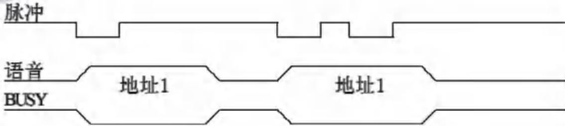
备注：负脉冲触发。当 I/O 口检测到有下降沿时（如，该 I/O 口对地短路一下），触发播放语音。在语音播放期间，再检测到下降沿时，芯片不动作。直到语音结束后，检测到的下降沿才有效。
