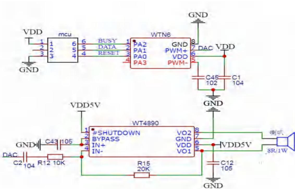
注意：布线时电容 C1 尽量靠近 WTN6 芯片 VDD 脚，以增强 WTN6 系列语音芯片的抗干扰能力。在 DAC 输出模式下，PWM-脚必须接 1nf 电容到地，DAC 输出可根据需求外接功放，以驱动更大功率的喇叭。
