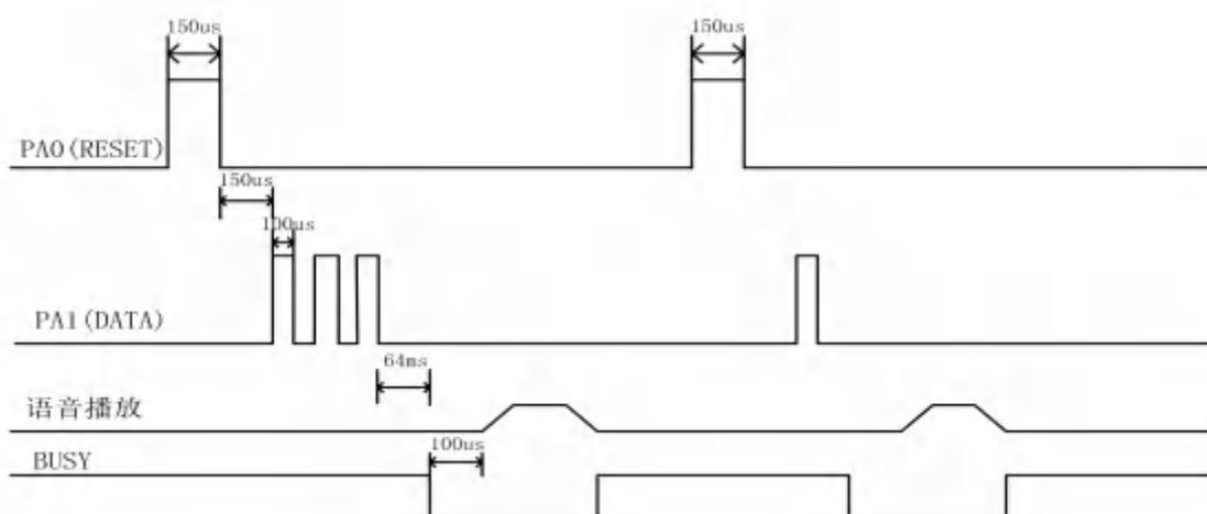
数脉冲控制时序中，先拉高 RESET 信号 150us，然后发送 DATA，DATA 中的脉冲高电平需要保持 100us 的高电平，且两个脉冲之间的间隔时间需要 100us。脉冲数据发送完后 64ms，BUSY 信号输出。BUSY 输出 100us 后开始播放地址语音，语音播放结束 BUSY 也发生变化。
