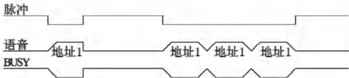
备注：当 I/O 口为低电平时，保持播放，高电平则停止。当第一遍结束后，还保持低电平，则继续重新播放，直到转变为高电平才停止。只要是低电平，则有声音；高电平，则没声音。
