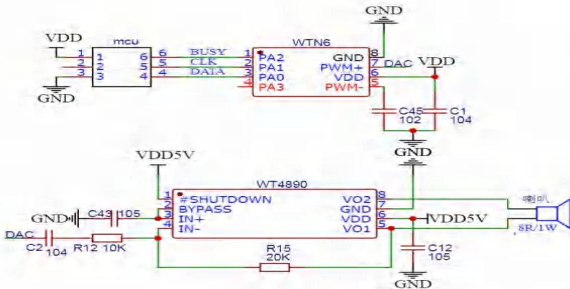
注意：布线时电容 C1 尽量靠近 WTN6 芯片 VDD 脚，以增强 WTN6 系列语音芯片的抗干扰能力。在 DAC 输出模式下，PWM-脚必须接 1nf 电容到地，DAC 输出可根据需求外接功放，以驱动更大功率的喇叭。
