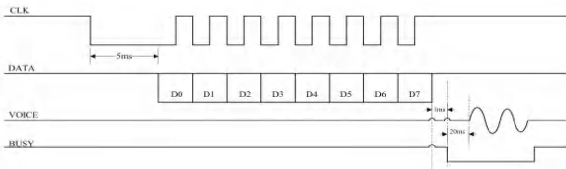
两线串口控制模式由片时钟 CLK 和数据 DATA 进行控制操作，每发一个字节数据前，时钟信号 CLK 拉低 4ms 至 20ms，推荐使用 5ms 以唤醒 WTN6 语音芯片，接收数据低位在先，在时钟的上升沿接收数据。时钟周期介于 40us~3.2ms 之间，推荐高低电平持续时间各使用 300us（即一个 bit 发送的时钟周期为 600us）。发数据时先发低位，再发高位。数据中的 00H~DFH 为语音地址指令，E0H~EFH 为音量调节命令，F2H 为循环播放命令，FEH 为停止播放命令。
